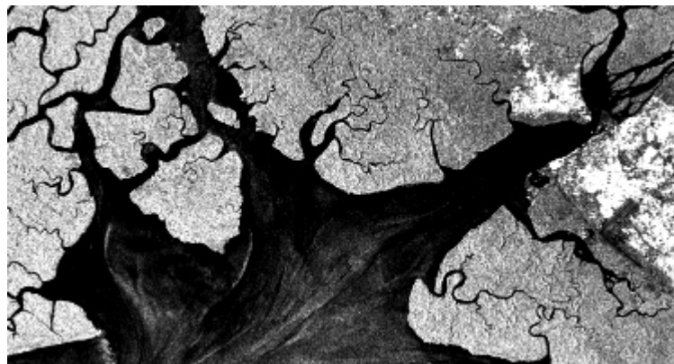
Figure 1.3 Portion 375 x 200 pixels d'une image en niveaux de gris. Il s'agit d'une image ERS1 (12.5 m de résolution) de la côte atlantique Camerounaise.
